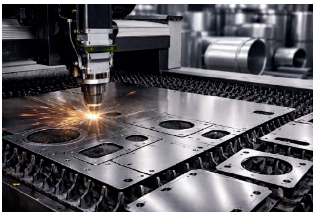
Blechzuschnitt mit Laser
